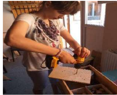
Executarea găurilor pentru decuparea formelor interioare
